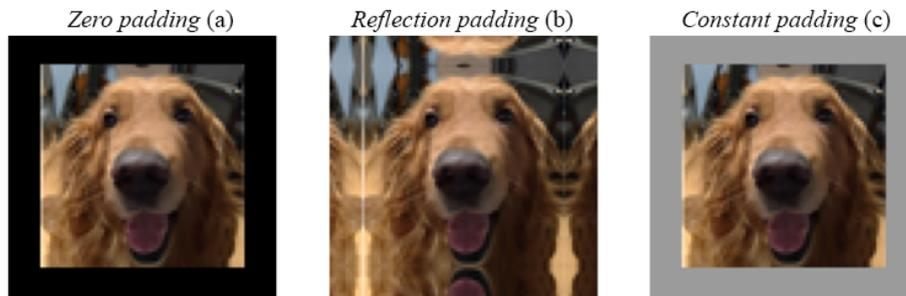
Figura 2.11: Aplicação de *padding* em imagens. Em (a) a imagem original passou por *zero padding*, que inseriu uma borda com valor 0 (preto) ao redor dela. A imagem em (b) é resultado do *reflection padding*, que criou bordas a partir da reflexão da imagem interna. Em (c), assim como em (a) a imagem passou por um *padding* constante, mas com um valor diferente de 0, nesse caso.
